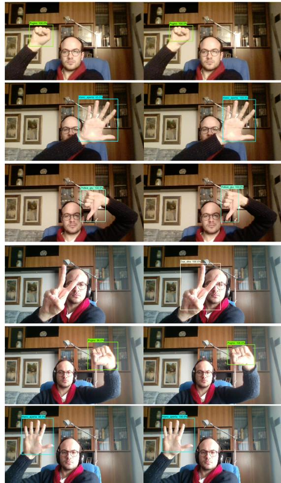
Figure 11. Esempi test SSD. Per ogni coppia di immagini, sulla sinistra abbiamo la predizione della SSD, sulla destra il ground truth.
